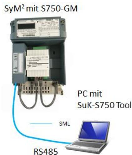
Abbildung 8: Lokaler Anschluss des SuK-S750 Tools über RS485 Schnittstelle des Kommunikationsmoduls
