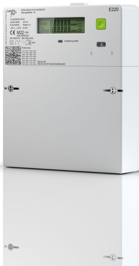
Die moderne Messeinrichtung E220 Serie 3 erfüllt die Anforderungen aus dem Gesetz zur Digitalisierung der Energiewende. Der Zähler folgt nahe den FNN Lastenheftern für Basiszähler und kann als Drehstrom- oder als Wechselstromzähler eingebaut werden. Der E220 ist ein SLP Zähler, der an der optionalen LMN-Schnittstelle auch die GRID-Werte zur Verfügung stellt. Als Optionen sind verfügbar ein 2-Tarif-Modul, ein je LMN-Module für RS-485 und wMBus.
