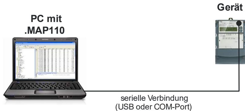
Sie benötigen dazu ein betriebsbereites Gerät und einen optischen Lesekopf für den Anschluss an einer seriellen Schnittstelle (USB oder COM-Port). Ferner muss das Landis+Gyr .MAP110 Service Tool auf Ihrem PC installiert und z.B. für die Benutzergruppe "Installation" lizenziert sein.
